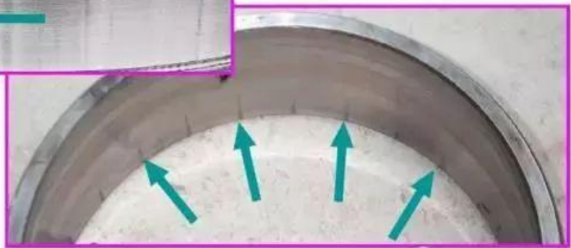
內圈和外圈滾道表面被敲坏的痕迹
